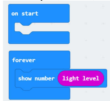
Hình 30: Chương trình kiểm tra giá trị cảm biến ánh sáng
