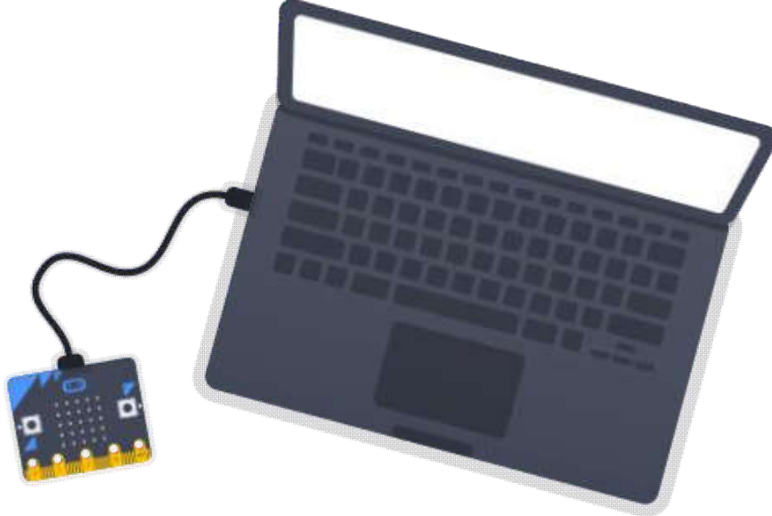
Hình 2: Kết nối mạch MicroBit với máy tính thông qua dây USB
