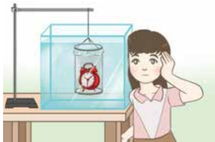
▲ Hình 12.3. Thí nghiệm tìm hiểu sự truyền sóng âm trong nước
