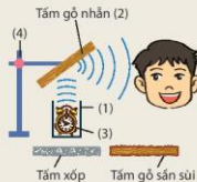
Hình 14.3 Bố trí thí nghiệm phản xạ âm
