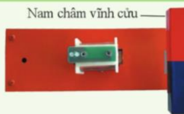
Hình 11.7. Thí nghiệm cảm ứng điện từ với nam châm quay
