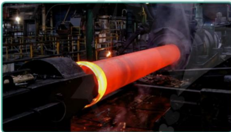
Hình 17.6. Thép được đúc thành ống trong quá trình làm nguội
