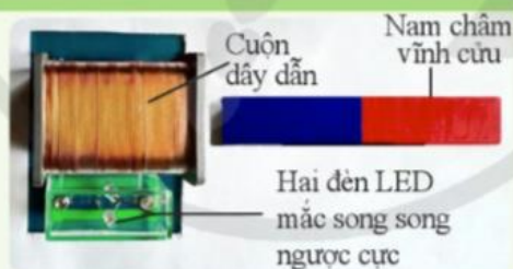
Hình 11.2. Thí nghiệm cảm ứng điện từ với nam châm vĩnh cửu
