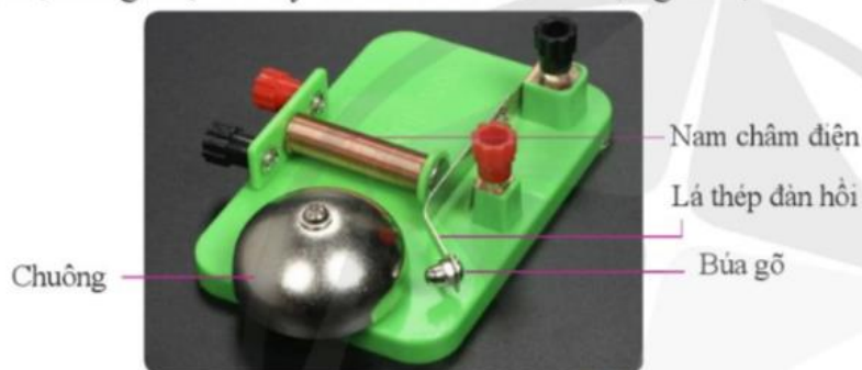
Hình 12.3. Cấu tạo của chuông điện
