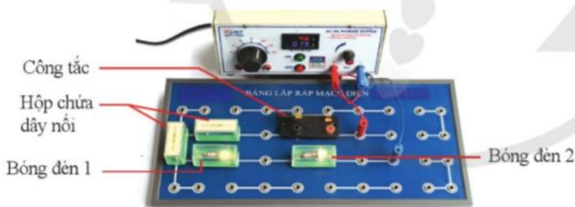
Hình 8.2. Mạch điện gồm hai đèn mắc nối tiếp
