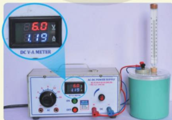
Hình 10.5. Sơ đồ thí nghiệm khảo sát sự phụ thuộc năng lượng điện vào cường độ dòng điện
