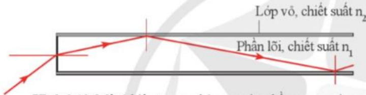
Hình 3.10. Mô tả hiện tượng phản xạ toàn phần trong sợi quang
